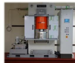
キュービックアンビル型高圧合成装置（H26導入）
