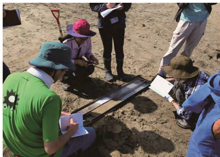
図4 ジオスライサーを用いて海浜の地下の堆積物を掘削して構造を観察している様子。波崎海岸にて
